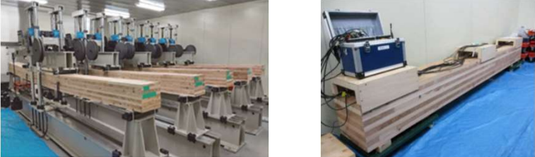
9層9プライCLTの性能評価試験の状況
