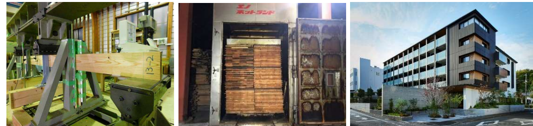
横架材の性能で重視される強度やヤング係数の検証
