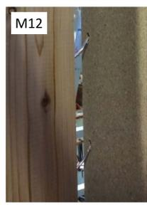
写真2. 釘の引き抜け
