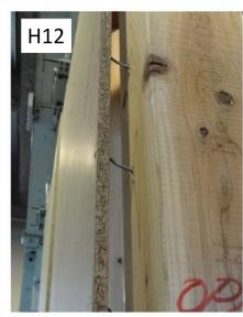
写真4. 釘の引き抜け
